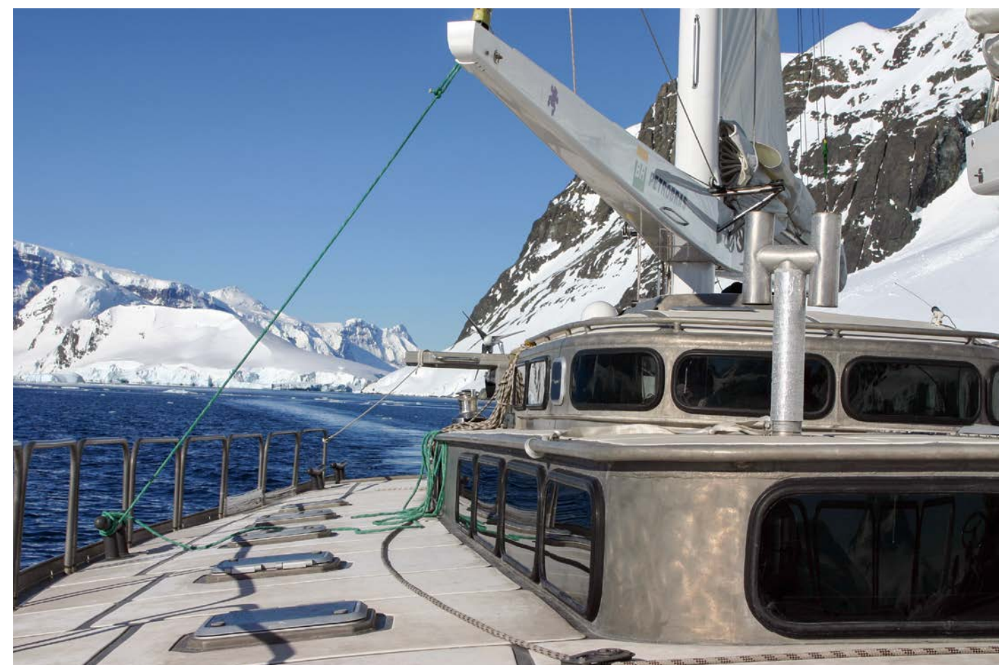
O convés do veleiro Paratii 2, com cordas de polipropileno, que hoje se deterioram mais rápido pela ação dos raios ultravioleta
